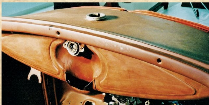
Die bekende valtoevoertenk in die tussenkap van die Model A Ford.
