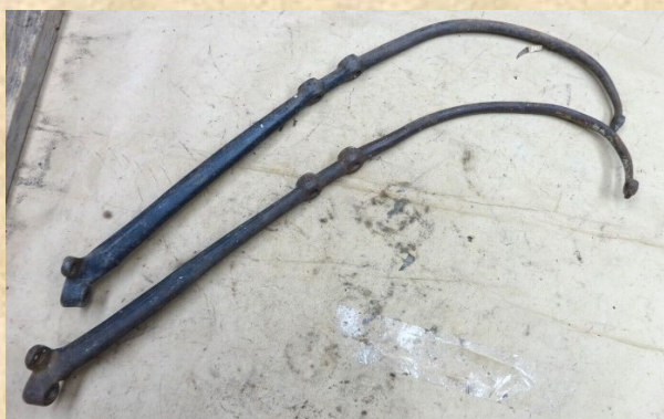
Vroeë Model A gegote steunstawwe vir die modderskerms
