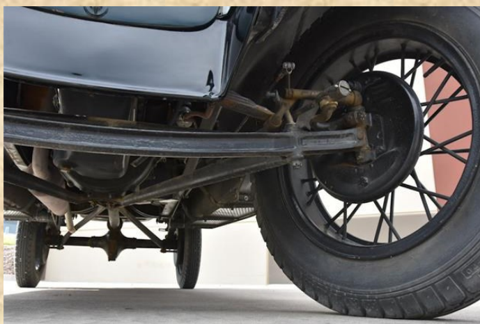
'n Goeie foto wat die unieke 1928 Model A Ford suspensie aandui.
