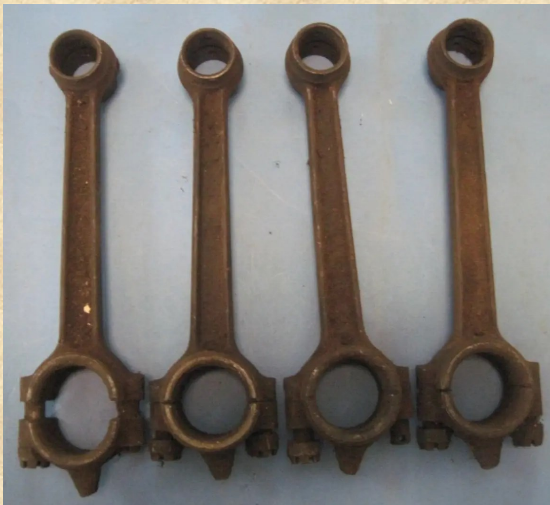
Tipiese latere 1928 Ford Model A gewone I-seksie suierstange met witmetaallaers.
